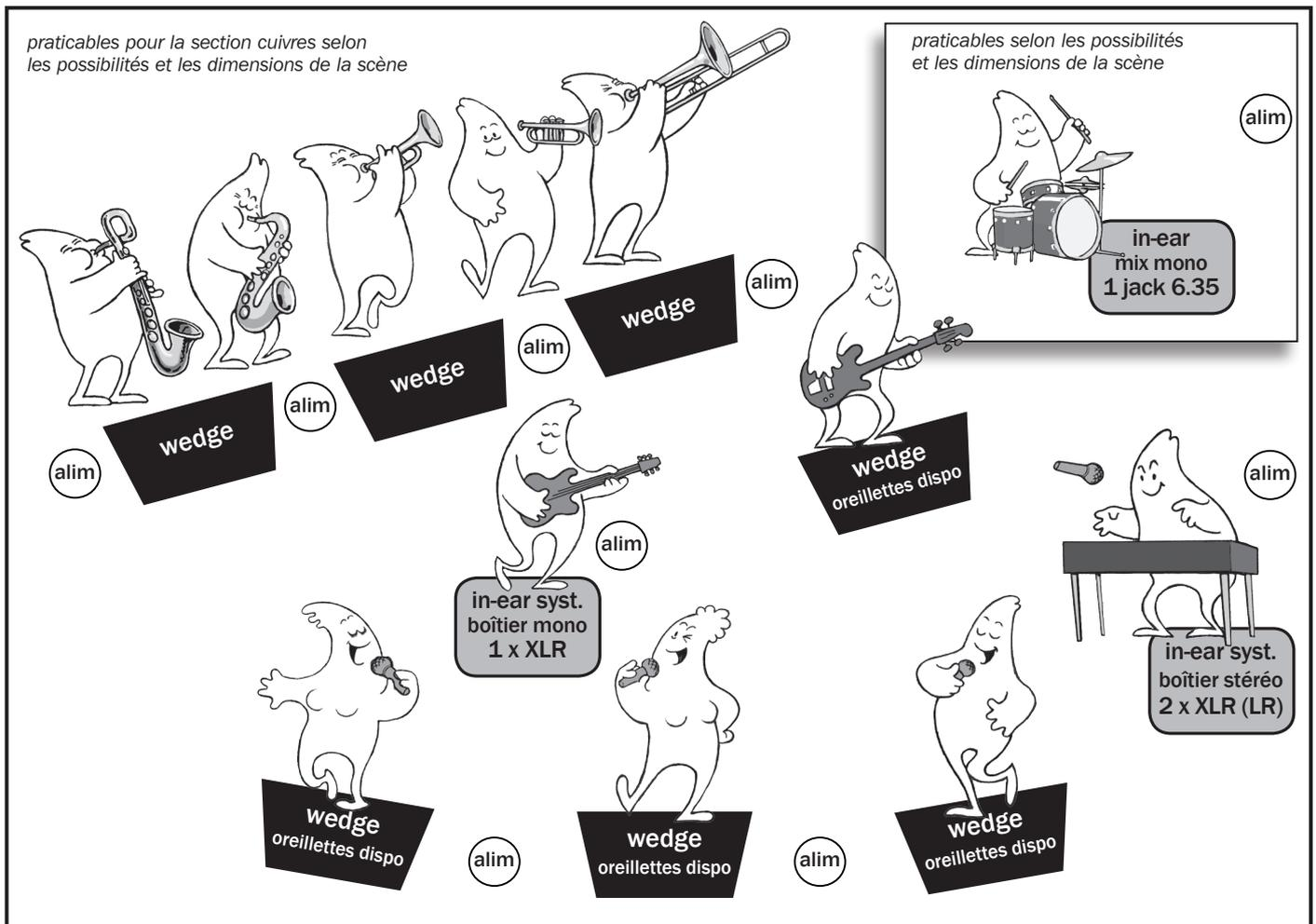
*Dimensions minimales recommandées de la scène : ouverture = 7m - profondeur = 4m
